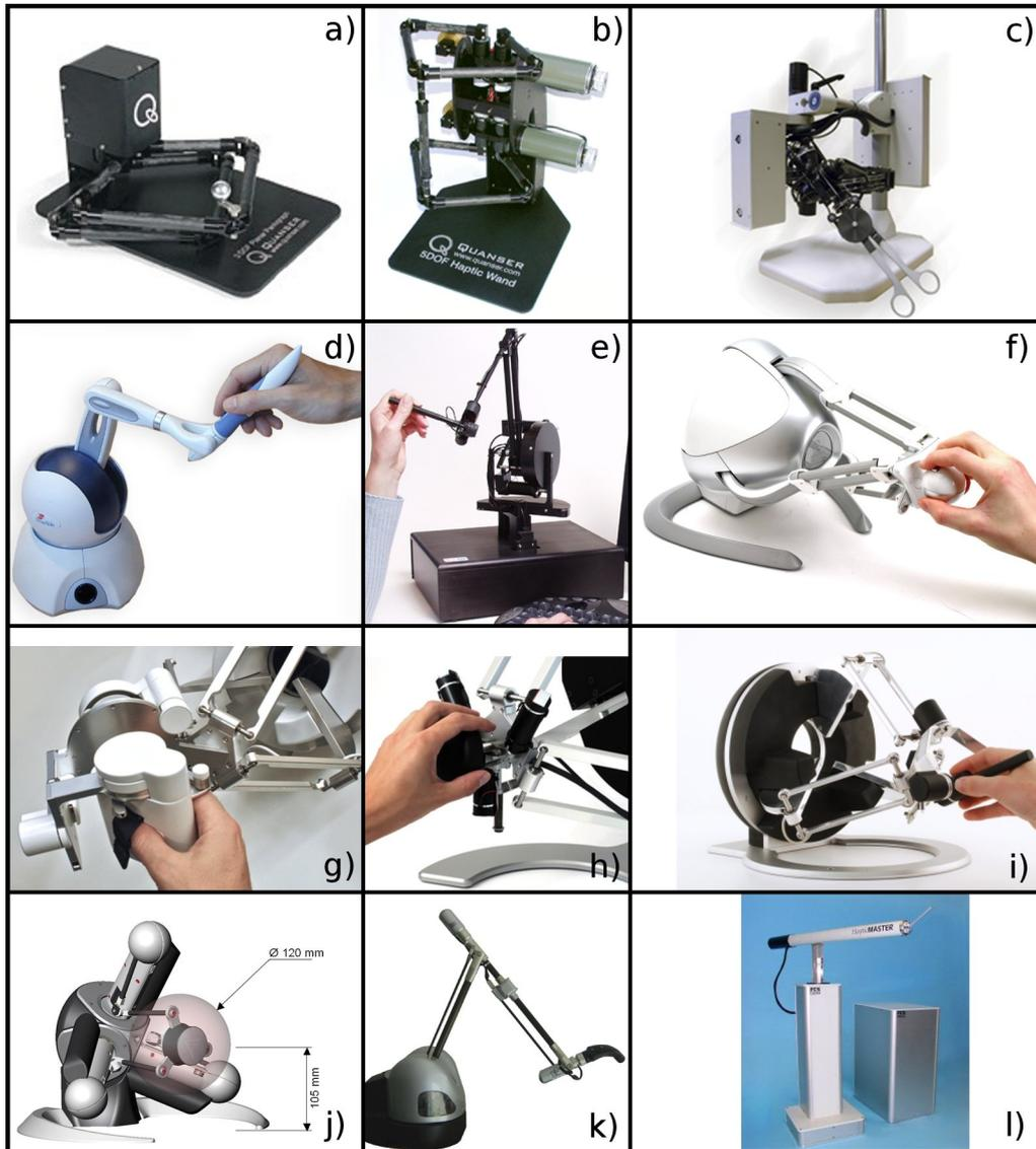
**Figura 2.13:** Algunos de los dispositivos hápticos existentes: a) Quanser 3DOF Planar Pantograph; b) Quanser 5DOF Haptic Wand; c) MPB Freedom 7S; d) Sensable Phantom Omni; e) Sensable Premium; f) Novint Falcon; g) ForceDimension Sigma 7; h) ForceDimension Delta 6; i) ForceDimension Omega 6; j) Haption Virtuose 6D Desktop; k) Haption Virtuose 6D35-45; l) Moog FCS HapticMaster.
