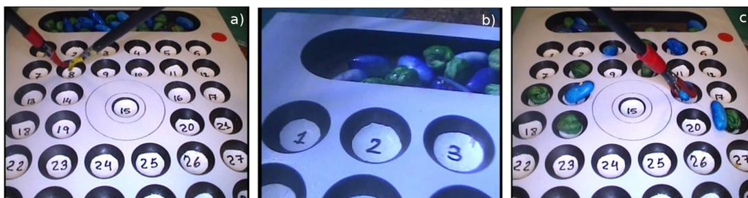
**Figura 5.22:** Ejemplo de ejercicios analizados por el software VidLA: a) coordinación ojo-mano, llevando las dos pinzas a la cuenca número ocho; b) manipulación de cámara, centrando la imagen de cámara en la cuenca número dos y c) coordinación mano-mano, colocando elementos como garbanzos y alubias en las cuencas definidas.
